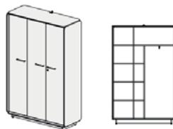
Боковины и крышки выполнены в виде «пирога», снаружи ДСП 10 мм окромкована кромкой ABS 2 мм, а внутри - МДФ 19 мм покрыта пленкой PVC толщиной 0,4 мм методом вакуумного прессования. Полки, нижний полка и задняя стенка из ДСтП толщиной 18 мм, кромка ABS 1мм.
